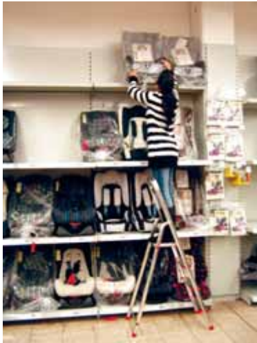
Bild 10: Stufenstehleiter mit Plattform
