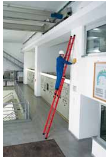
Bild 45: Sicherer Stand auf der Anlege-Schiebeleiter
