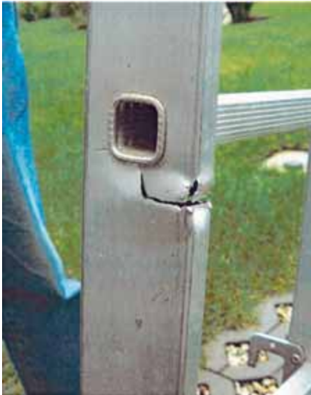
Bild 51: Stark beschädigte Leiter
