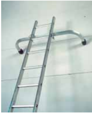
Bild 28: Wandabstützung (Verbreiterung des Leiterkopfes)
