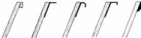
Bild 30: Aufsetz-, Einhak-, Einhängenvorrichtung
